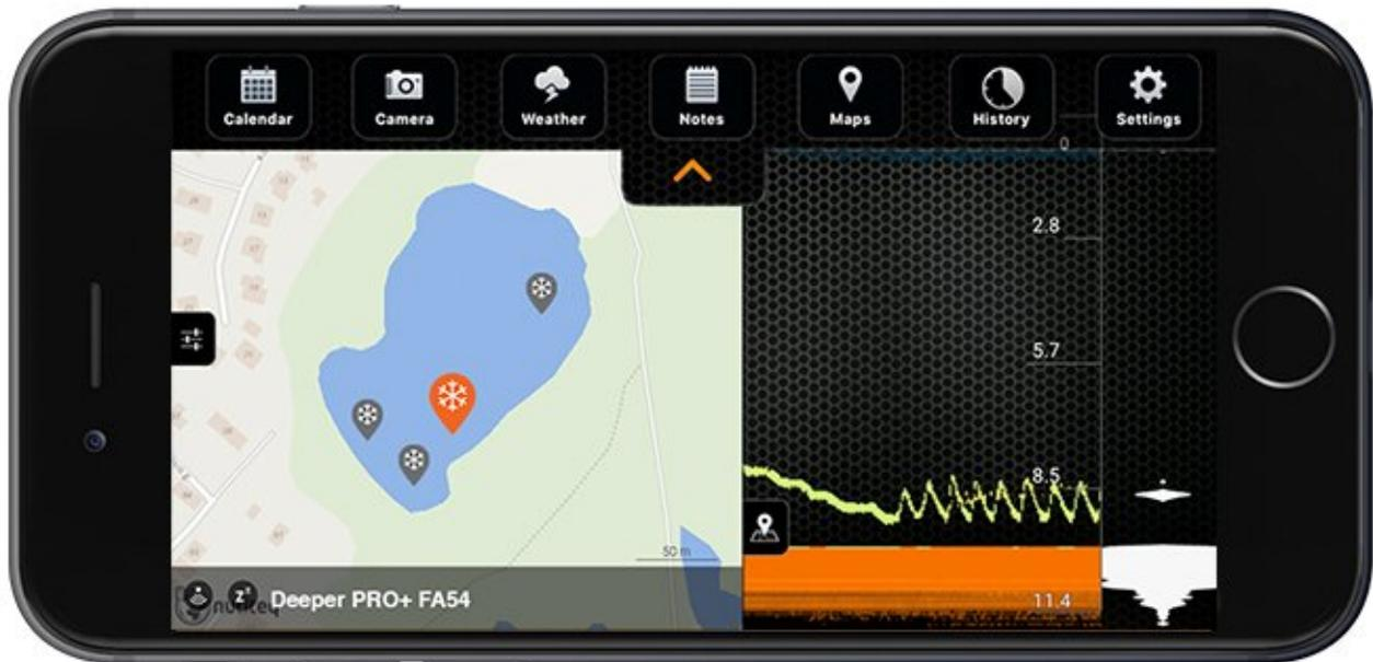
アイスフィッシングモードにはマッピング機能もあります（この機能が確実に機能するには、ユーザー登録が済んでいること、釣りをしている地域のオフラインマップをダウンロードがあらかじめダウンロードされていることを確認してください）。ディスプレイの左側に地図アイコンが表示されます。これをクリックすると、現在地を示す地図が開きます。あなたが氷の穴にあなたのDeeperを浮かべたとき、その場所は自動的にあなたのマップに印が付けられて保存されるでしょう。あなたがより多くの氷の穴で釣るにつれて、これらもあなたの地図に追加されます。これらの場所のいずれかをクリックすると、その場所の深度が自動的に表示されます。あなたの釣行後、アプリの履歴メニューに行き、釣行をクリックすると見返すことができます。その時のすべての氷の穴が地図が表示されます。それぞれの位置をクリックすると、その場所のスキャン画面、水温、日付と時刻が表示されます。
